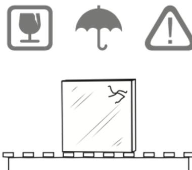
Las piezas de piedra requieren un manejo cuidadoso durante su almacenaje, manipulación e instalación para evitar rupturas, astillado en los bordes o rayado en la superficie. Almacene las piezas bajo techo, sobre una estiba, siempre en posición vertical y con las caras brillantes enfrentadas
